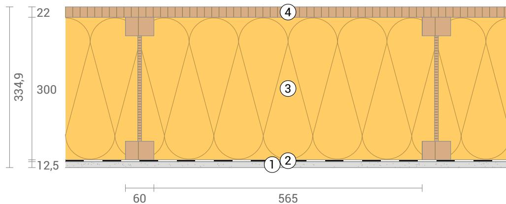
STROP\_pod poddaszem nieogrzewanym, U=0,127 W/(m<sup>2</sup>K)
